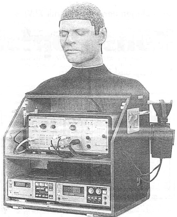
2: Kunstkopfaufnahmesystem von HEAD-Acoustics, entwickelt am IENT der RWTH Aachen.
